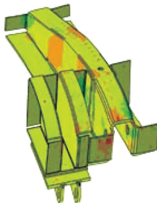
图4 FEA结果显示的吊耳上的最大局部应力
